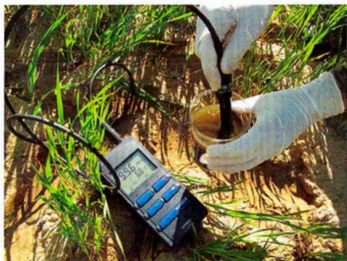
Figura 4. Un aparell Quantofix (esquerra) i un conductímetre (dreta). Ambdós aparells permeten estimar el contingut dels purins en els principals nutrients.
