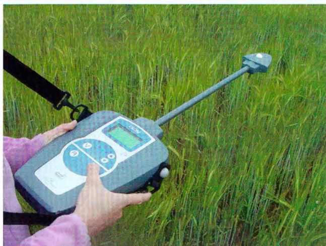
Figura 7. Tipus de sensors òptics manuals utilitzats. N-tester (esquerra) i GPN (dreta)
