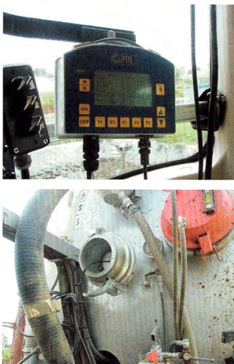
Figura 5. Imatges de la sonda (esquerra) i el monitor (centre), situat a la cabina del tractor, de l'equip Fertimeter® (conductímetre per a instal·lació en cisterna) i de la sonda col·locada a la cisterna (dreta) per fer les lectures de riquesa en nutrients del purí.
