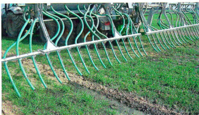
Figura 6. Els aplicadors de tubs penjants o mànegues són els adequats per fer aplicacions de dejeccions líquides en cobertora, quan el cultiu ja està establert.
